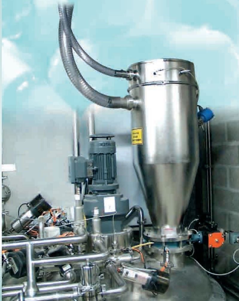
Démontage facilité par raccords clamp
